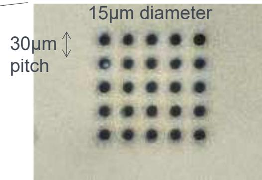
Hole diameter : 15μm
